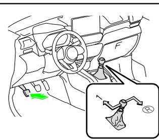
2. Pise el pedal del embrague y mueva la palanca de cambios a la posición de la 1ª marcha o la marcha atrás (R). \*2
